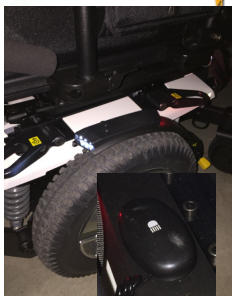
Système de lumières sur les ailes avec egg switch
