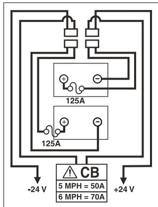
Diagramme de câblage des batteries
