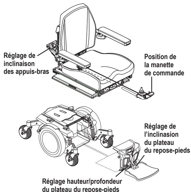
Figure 5. Vue de l'assemblage du fauteuil
