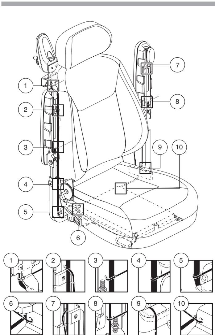
Figure 10. Câble sécurisé sur un siège avec iLevel
