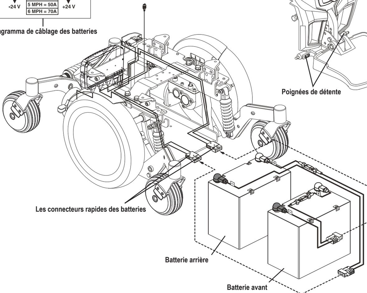
Figure 25. Installation des batteries
