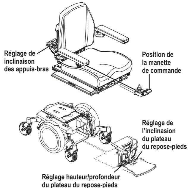
Figure 5. Vue de l'assemblage du fauteuil
