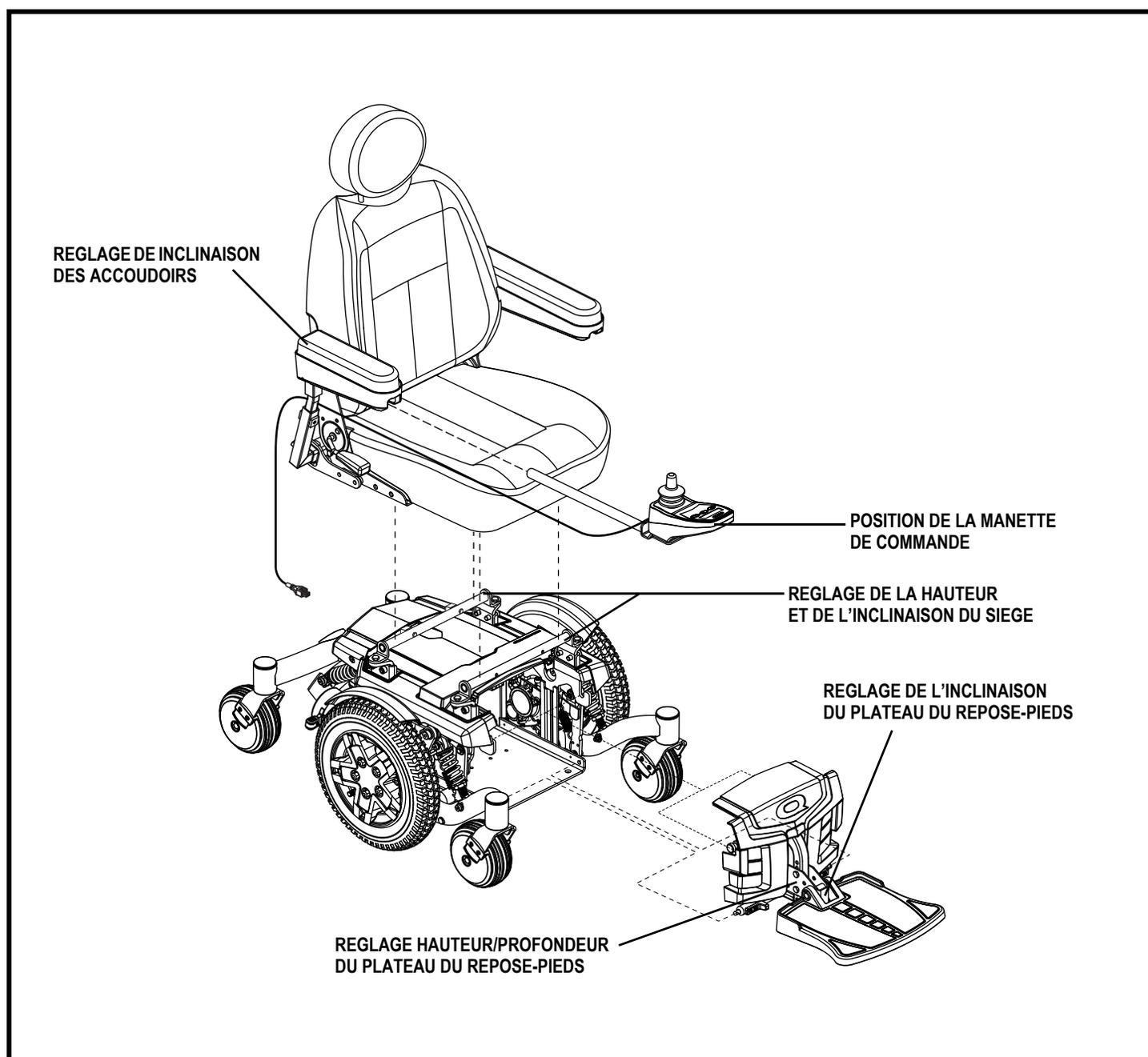
Figure 6. Vue de l'assemblage du fauteuil Q6 Serie
